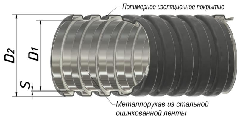
Рисунок 1. Металлорукав типа РЗ-ЦП нг-LS с протяжкой
