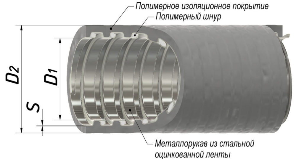
Рисунок 1. Металлорукав типа МПГ нг серый с протяжкой
