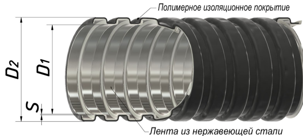
Рисунок 1. Металлорукав типа РЗ-Н с протяжкой
