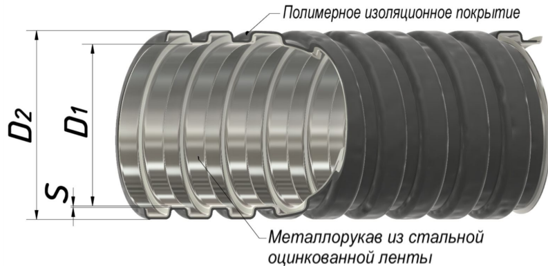
Рисунок 1. Металлорукав типа РЗ-ЦП нг-LS с протяжкой
