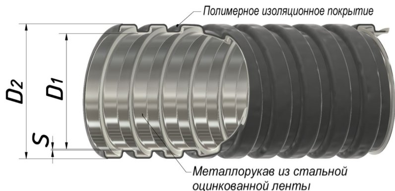
Рисунок 1. Металлорукав типа РЗ-ЦПнг
